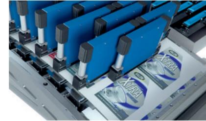
Les contrôleurs à micromoteur alignent précisément chaque tête d'impression, pour créer une image sans raccord sur la feuille ondulée et fournir une qualité d'impression supérieure.
