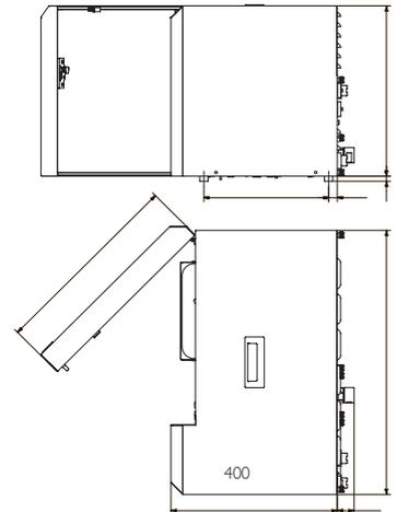
Mittleres Tintenversorgungsgehäuse für alle Drucksysteme mit mehr als drei Druckmodulen
